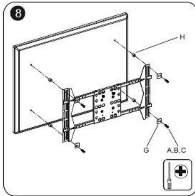
9. Lo siguiente que haremos será ajustar la estructura y el tubo al televisor, la atornillaremos y ajustaremos de tal forma que el televisor quede pegado a toda la base.
